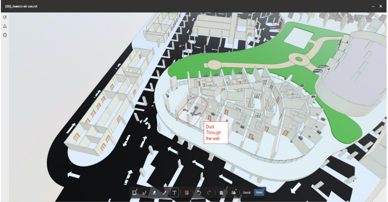
شكل رقم (7) – عمل Issues & Mark Ups على الموديل عبر BIM 360
